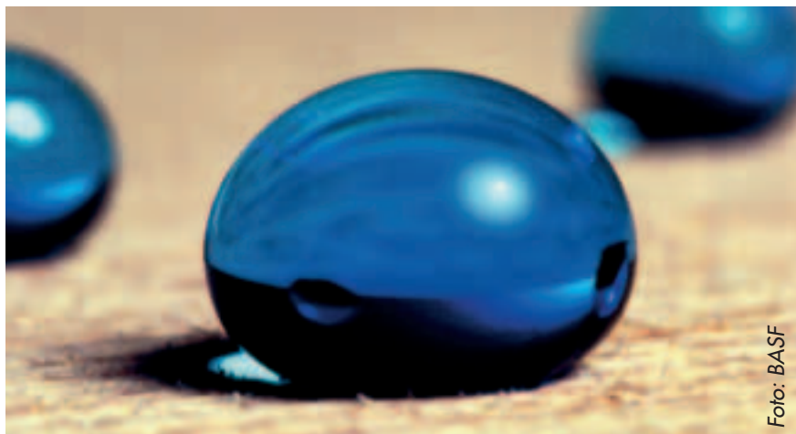
Wassertropfen auf nanotec-behandelter Oberfläche
